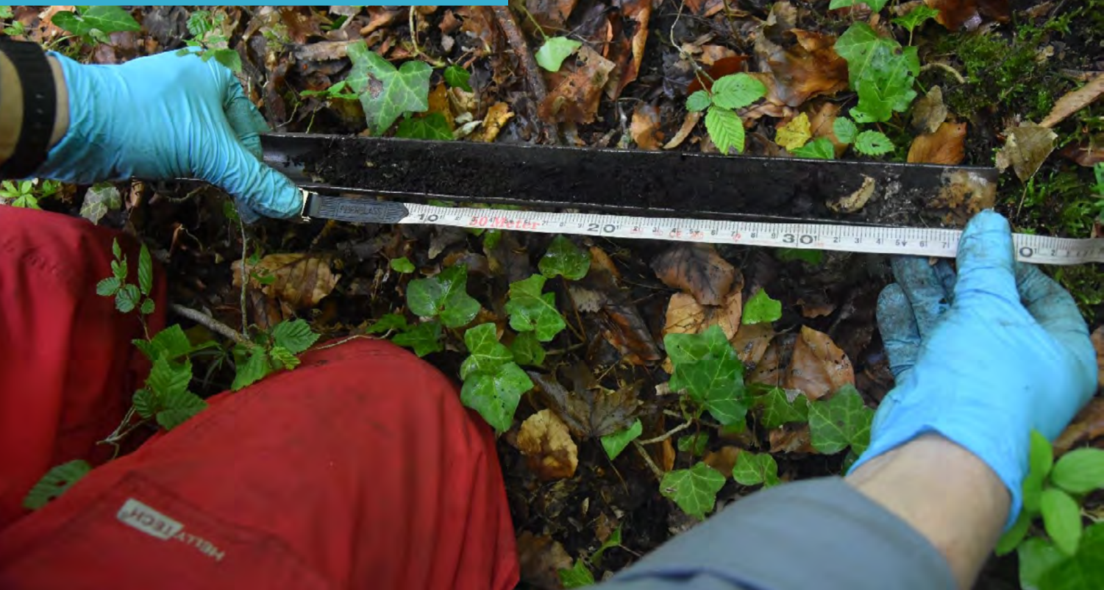
Mesure de l'épaisseur de la couche de charbon de bois à l'aide d'une tarière. La couche de charbon de bois est une couche sombre plus ou moins épaisse constituée de terre mélangée à des restes de la production de charbon de bois, à savoir des fragments de charbon de bois et des cendres.
