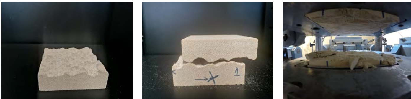
Figure 3 a et b) Éprouvettes de cisaillement imprimées avant cisaillement à l'aide de la technique « Binder Jetting » c) éprouvette après cisaillement
