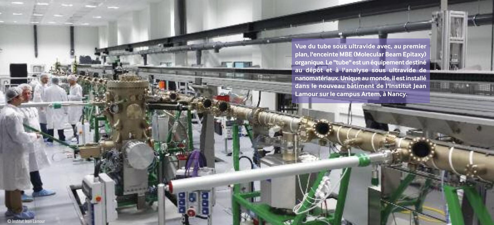
Vue du tube sous ultravide avec, au premier plan, l'enceinte MBE (Molecular Beam Epitaxy) organique. Le "tube" est un équipement destiné au dépôt et à l'analyse sous ultravide de nanomatériaux. Unique au monde, il est installé dans le nouveau bâtiment de l'Institut Jean Lamour sur le campus Artem, à Nancy.
