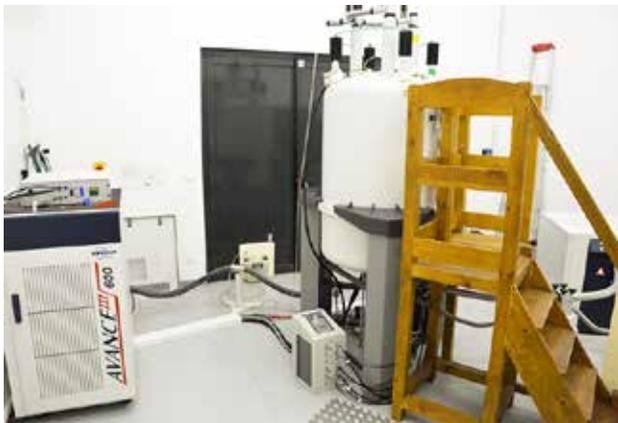
**Spectromètre : Spectromètre RMN 600 Mhz (Bruker Avance III)**
