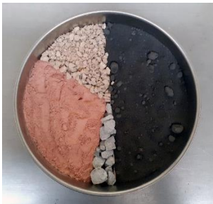
Mélange de l'argile avec du clinker, de l'anhydrite et du calcaire avant broyage. A gauche de haut en bas : calcaire, argile, anhydrite. A droite : clinker Télécharger la photo ICI .
