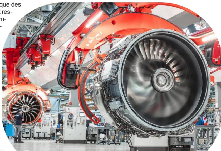
*Une ligne d'assemblage pour le moteur LEAP, à l'usine Safran Villaroche, à Réau (77). PHOTO ILLUSTRATION DR SAFRAN/ADRIEN DASTE*
