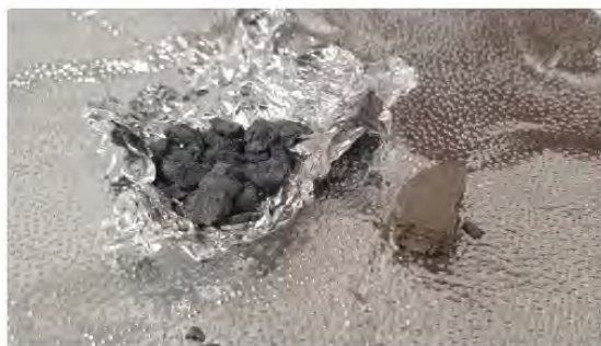
A gauche des morceaux d'hydrures de magnésium ( MgH_2 ), à droite, un magnésium pur qui n'a rien absorbé. ■ © Adrien Heinzelmeyer
